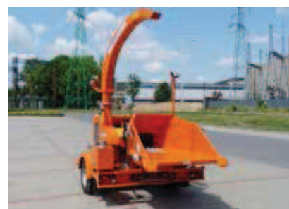
W modelu Skorpion 280 SDBG zastosowano bęben płaszczowy
