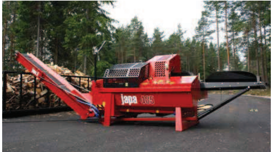
Największym modelem w ofercie jest 485 – umożliwia bezproblemowe łupanie nawet powykręcanych kłód o średnicy do 48 cm
