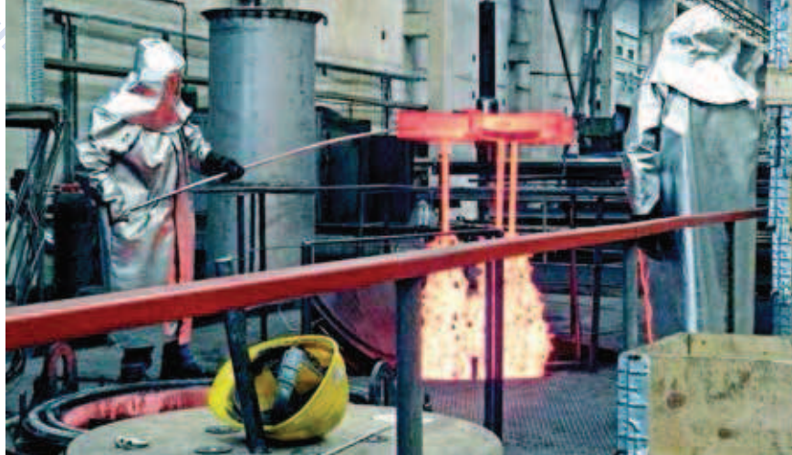
Łańcuchy Trygg wykonywane są z dwóch warstw stali
